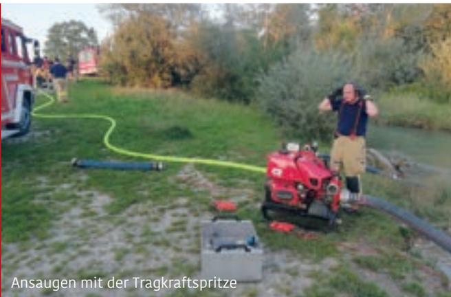
Ansaugen mit der Tragkraftspritze
